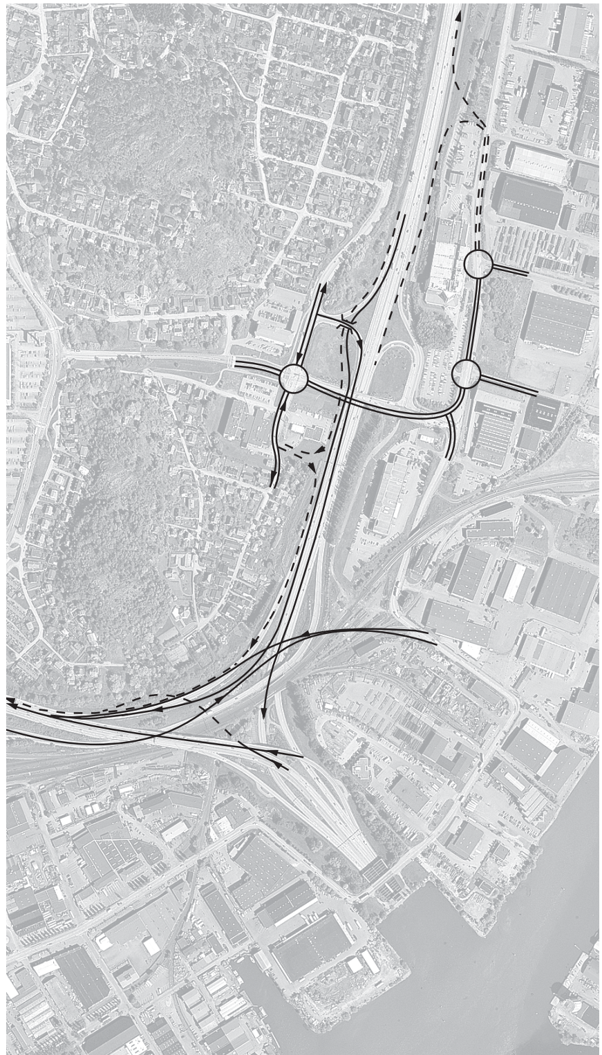
BILAGA RINGÖ-/TINGSTADSMOTET (principskiss av trafikkontoret) Förslag till kompletteringar av Ringömotet för att "försortera" trafiken till Lundbyleden resp. Brunnsbomotet/Tuveleden/Backaplan. Förslag till av- och påfarter i Tingstadsmotet för att förlänga vävsträckor samt "försortering" till Lundbyleden, lokalvägnätet resp. Tingstadstunneln.
